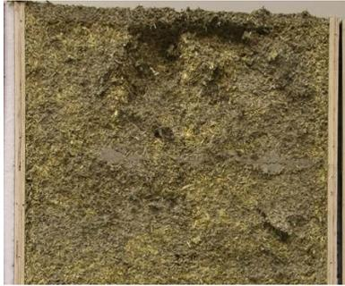
*Foto 5: Ungleichmäßiger Hanfbeton mit punktueller Ablösung.*
