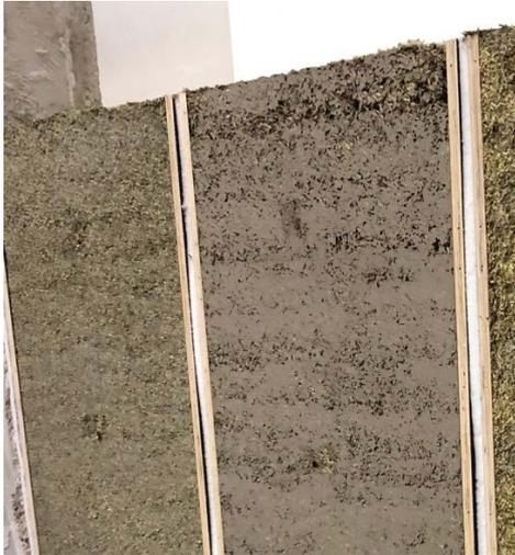
*Foto 3: Hanfbeton, der auf seiner Oberfläche homogen ist.*
