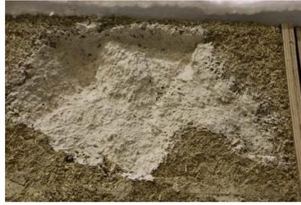
*Foto 6: Hanfbeton, der mit einer Bindemittelschlämme befeuchtet wurde, die die gleiche Zusammensetzung hat wie das Bindemittel, das ursprünglich zur Herstellung des Hanfbetons verwendet wurde.*
